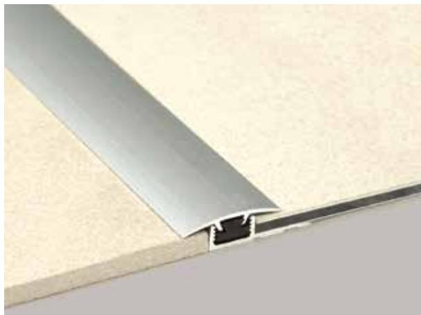
Perfil de unión para suelos LVT/SPC coplanares patentado. Innovador, porque el ingenioso sistema con clip de Resinil permite, girando, compensar incluso pequeñas diferencias de nivel de hasta 1,5 mm. El sistema utilizado con CLB60ANF (base) y CL40P (Clip) también permite conectar pavimentos de 4 a 6 mm de espesor. Actúa como una junta de dilatación, gracias a la cavidad interna que permite un movimiento de los pavimentos subyacentes de  $\pm 2$  mm.
